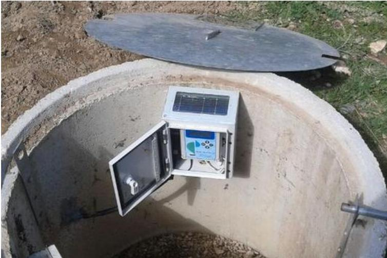
El ESPAY-gprs mantiene la característica de autonomía energética del SP-DURCAS. Vale decir que no requiere ningún tipo de alimentación externa de corriente ya que cuenta con una pequeña placa solar y una batería que le permite mantener la medición y registro de las medidas.
