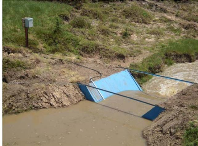
El equipo, mide el caudal, acumula el volumen, guarda el valor en su datalogger, envía periódicamente los registros al módem para que este los incorpore a la base de datos y revisa si ha recibido algún sms u otro tipo de comunicación con órdenes del usuario y las ejecuta, devolviendo una respuesta por sms, email o directamente al alojamiento web donde se encuentra la base de datos y archivos de información.
