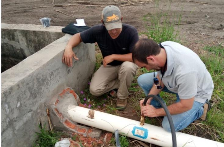
La reducida profundidad de inserción del sensor dentro del tubo reduce las posibilidades de que elementos en suspensión o flotantes se enganchen en el mismo alterando la medición.
