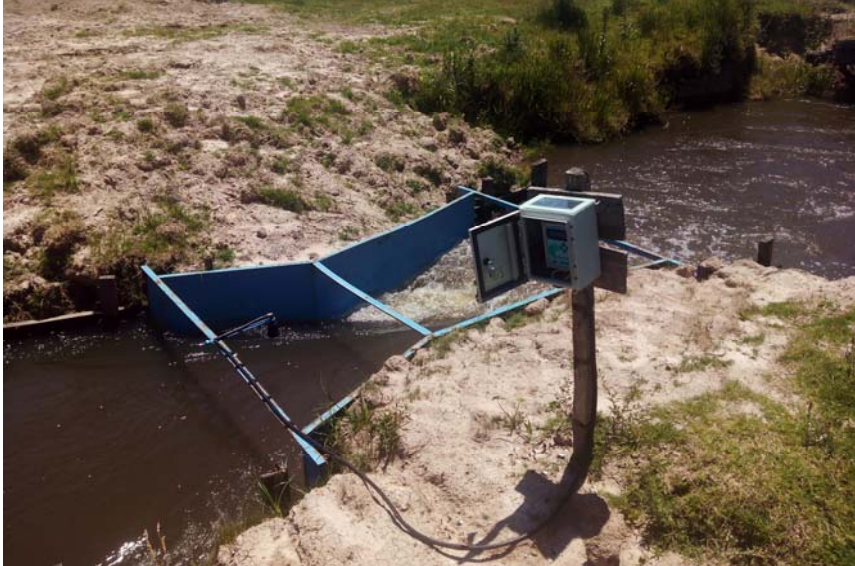
Ilustración 3 Medidor ESPAY-gprs con Ecosonda midiendo carga en Aforador Sin Cuello N° 24, para el cálculo de caudal y volumen de riego.
