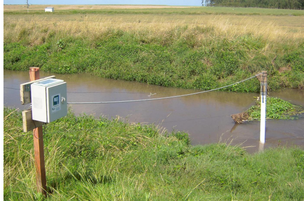
Medición de profundidad de agua en canal de riego (en tierra)
