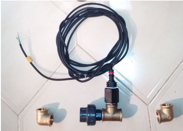
Sensor hDif de presión diferencial (diferencia de columna de agua)
