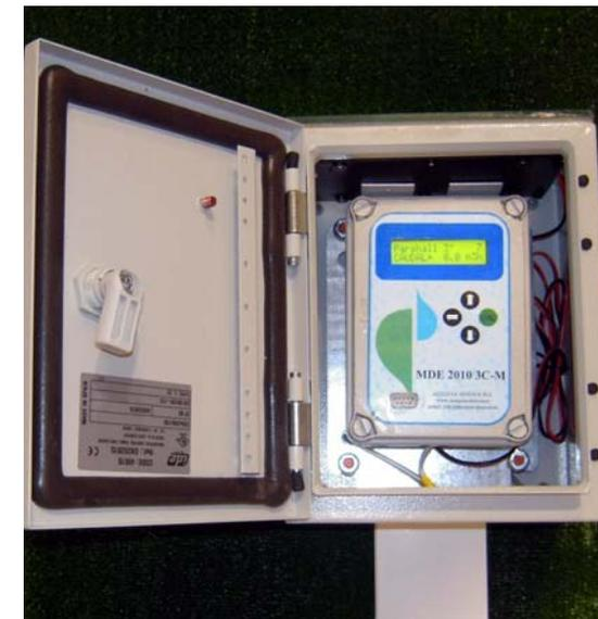
El corazón del ESPAY es la consola de registro MDE-gprs. Ésta transforma la carga del aforador medida por el sensor, en su correspondiente valor de caudal, acumulando el volumen. Estos valores se guardan en el datalogger y son enviados telemáticamente a través del módem.
