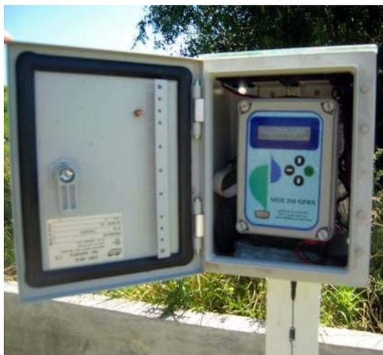
El ESPAY-gprs es absolutamente autónomo ya que integra una pequeña placa solar en la parte superior de la caja, que mantiene indefinidamente el funcionamiento del aparato, sin ningún tipo de mantenimiento.
