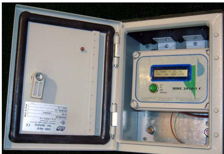
El SP-DURCAS puede utilizarse para la determinación de volumen de riego derivado a cada parcela, así como también en el control del volumen por sectores, dado que su funcionamiento es independiente del tamaño de la conducción y el caudal transportado.
